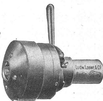
Nach dem Schneiden des Aussengewindes auf Revolverbänken kann dieser Kopf von Hand rasch mit dem Revolverschlitten zurückgezogen werden, wobei der Zeitverlust vermieden wird, der beim Herauswinden der Schneideisen sonst entsteht.
