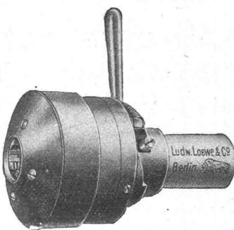
Nach dem Schneiden des Aussengewindes auf Revolverbänken kann dieser Kopf von Hand rasch mit dem Revolverschlitten zurückgezogen werden, wobei der Zeitverlust vermieden wird, der beim Herauswinden der Schneideisen sonst entsteht.
