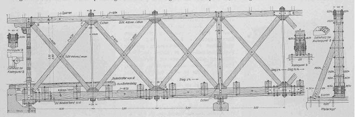
Abb. 5. Ansicht, Schnitt und Endknotenpunkte a und b des Howe'schen Brückenträgers. — Masstab 1:80.
