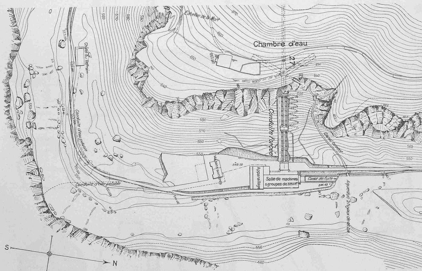
Abb. 10. Lageplan des Wasserschlosses, der Druckleitung und der Zentrale (letztere im ersten Ausbau). — Masstab 1:2500. (Photographische Verkleinerung des französisch beschrifteten Originalplanes.)
