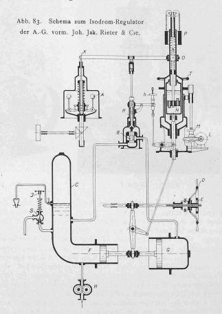
Die Veränderung der Höhenlage dieses Hohlkörpers T, entweder durch Drehung am Griffkranz, oder durch den Elektromotor L mit Schnecke, Schneckenrad und Stirngetriebe, erlaubt die Veränderung der Tourenzahl während des Ganges. Der Antrieb dieses Elektromotors kann durch die Friktionsvorrichtung M ein- und ausgerückt werden. Zwecks Begrenzung der Turbinenöffnung und um ein
