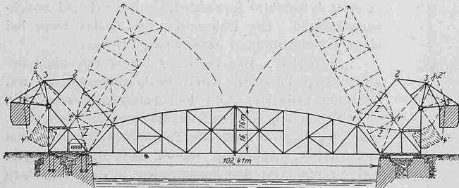
Da zur Zeit der Aufstellung der Brücke der Kanal noch nicht fertiggestellt war, konnte sie in geschlossenem Zustand auf einem Montagegerüst zusammengebaut werden, dessen Ständer in die Kanalsohle eingerammt waren. Ein auf einem 19 m hohen hölzernen Krangerüst stehender Derrick-Kran besorgte das Beibringen und Einsetzen der Konstruktionsglieder.
