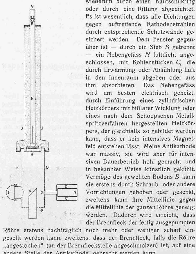
Röhre erstens nachträglich noch mehr oder weniger scharf eingesetzt werden kann, zweitens, dass der Brennfleck, falls die Röhre „angestochen“ (an der Brennfleckstelle angeschmolzen) ist, auf eine andere Stelle der Antikathode gebracht werden kann.
