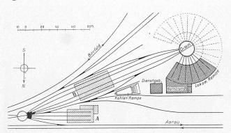
Abb. 1. Lageplan des Lokomotivdepot Brugg. — 1:3000.
