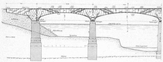
Abb. 23. Längsschnitt der Ergolzbrücke mit Längsträger-Armietung. — Masstab 1:200.
