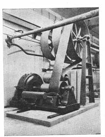
Papiermaschinen-Antrieb mit variabler Tourenzahl mit "Stufen-Lenix" Kraftübertragung 120 PS. Direkter Antrieb bei grössten Uebersetzungs-Verhältnissen und kleinsten Achsendistanzen.
