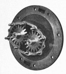
Abb. 19. Zahnräder-Oelpumpe.
