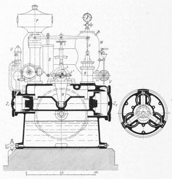
Abb. 15. Schnitt durch Differentialkolben und Oelpumpe. - 1:25.
