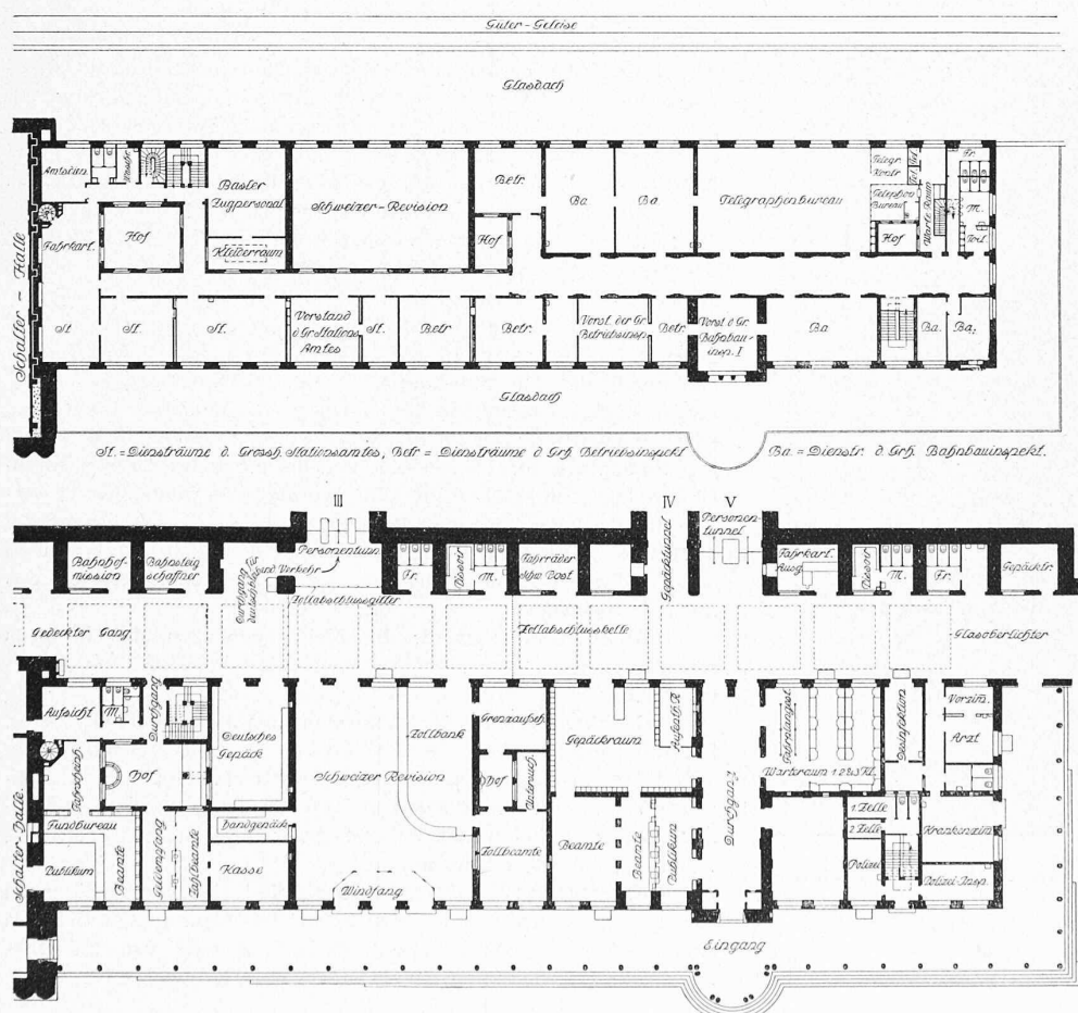
Abb. 5 u. 6. Grundrisse vom Erd- u. Obergeschoss des Bad. Bahnhofs, Schweizer Seite (rechter Flügel). — 1:700.
