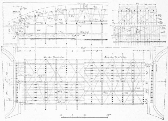
Abb. 18. Lehrgerüstplan der Hauptöffnung. - Mass(ab 1:425 (Cliché der «Deutschen Bauzeitung»).
