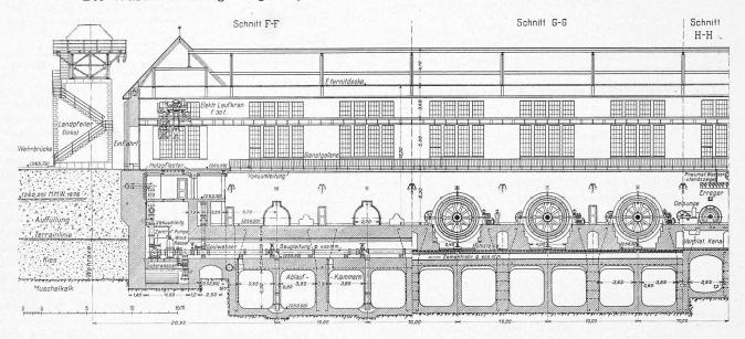
Abb. 12. Längsschnitte F bis H durch Maschinenhaus und Ablaufkammern (vergl. Doppeltafel 1 in Nr. 1). — 1:420.
