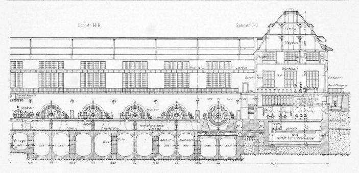
Abb. 13. Längsschnitte H bis J durch Maschinenhaus und obern Flügelbau (vergl. Doppeltafel 1 in Nr. 1). — Masstab 1:420.
