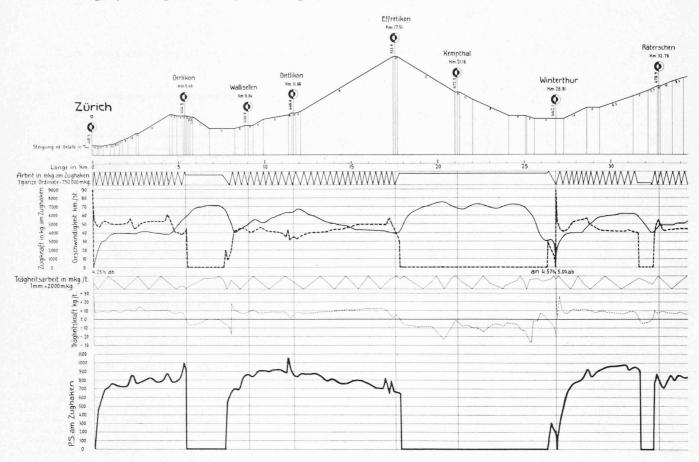
Abb. 38. Zug 14 (3. III. 1914) Lok. A<sup>3</sup>/<sub>5</sub> Nr. 608 Heissdampf, 106 t (bei <sup>2</sup>/<sub>3</sub> Vorräten); Zugsgewicht 374 t, 45 Achsen. Längenprofil: 1:200000, 1:4000.
