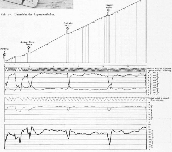
Abb. 39. Zug 878 (20. II. 1914). Lok, C 5/6 Nr. 2951 Heissdampf, 119 t (bei 2/3 Vorräten); Zugsgewicht 300 t, 46 Achsen. Längenprofil: 1:200000; 1:10000.
