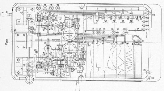
Abbildungen 28 und 29. Längsschnitt u. Draufsicht des Apparatentisches Masstab 1:12,5.
