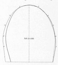
wärtig stehen wir in der Abb. 2. Deformiertes Tunnelprofil Periode des Maximums. bei Km. 3,293 ab S.-P. (7. VII 14.) — 1:100.
