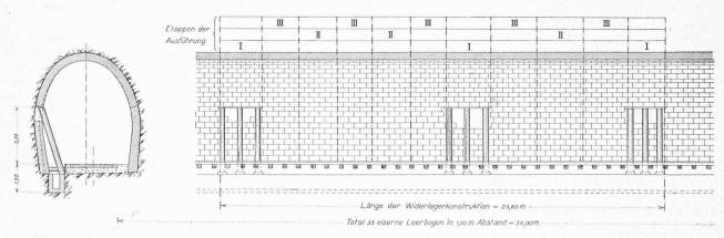
Abb. 4. und 5. Profil und Ansicht der Widerlager-Rekonstruktion von Km. 3,280 bis 3,303 im Simplon-Tunnel I. — Masstab 1:200.
