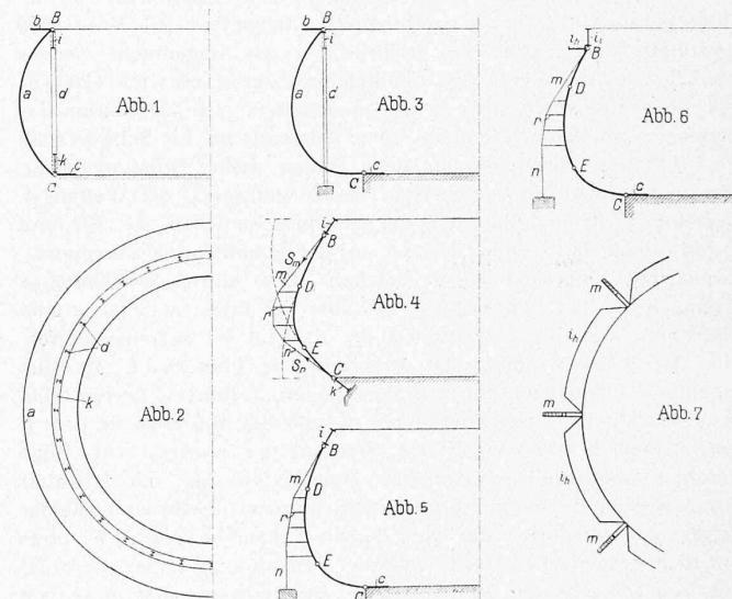
Es ist nun eine neue Form des Wölbbeckens möglich, die als charakteristisches Merkmal eine Wandkurve aufweist, die von der Seilkurve für den Flüssigkeitsdruck abweicht. Die Wandfläche muss aber wie bei der Konstruktion Augsburg-Nürnberg eine Rotationsfläche sein.
