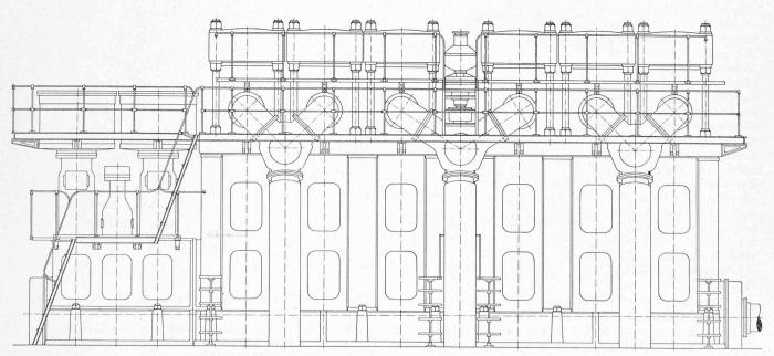
Abb. 1. Sechszylinder-Zweitakt-Sulzer-Dieselmotor für 4500 FS-Leistung. — Masstab etwa 1:75.
