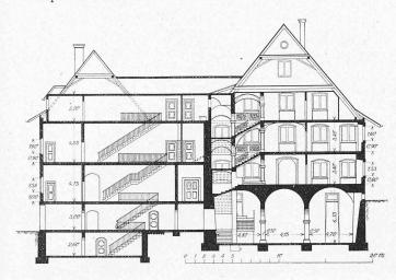
Abb. 9. Schnitt A-B durch Anbau und altes Haus. - 1:400.
