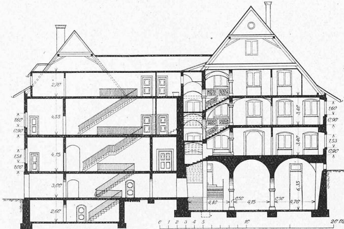
Abb. 9. Schnitt A-B durch Anbau und altes Haus. — 1:400.
