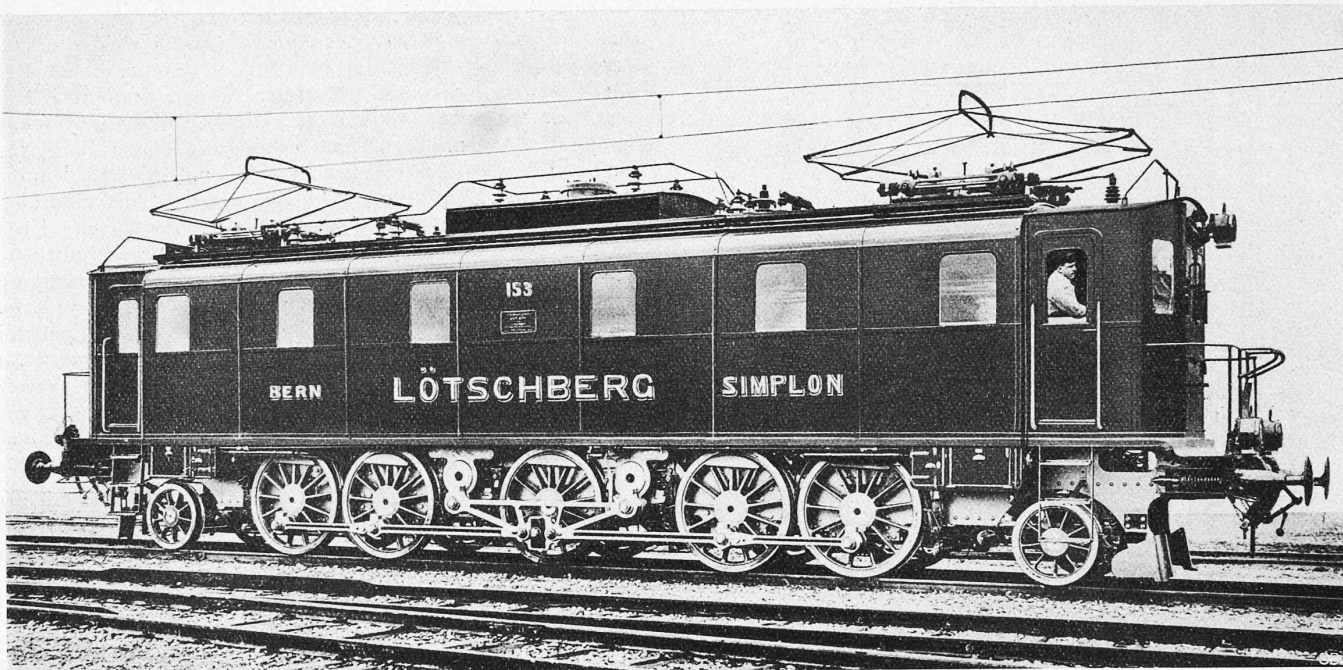
Abb. 5. Elektrische Lokomotive Serie 1-E-1 der B. L. S., gebaut von der Maschinenfabrik Oerlikon und der Schweiz. Lokomotivfabrik Winterthur.
