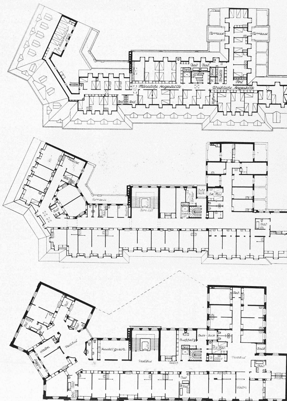
Abb. 8 bis 10. Grundrisse. — 1 : 500. — Unten: I. u. II. Wohngeschoss; Mitte: IV. Wohngeschoss [I. Dachstock]; Oben: Angestellten-Zimmer [II. Dachstock].
