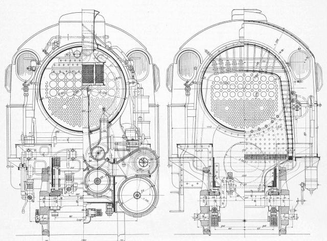
Abb. 3 und 4. Schnitte durch Rauchkammer, Kessel und Feuerbüchse der Vierzylinder-Verbund-Lokomotive. — 1:35.
