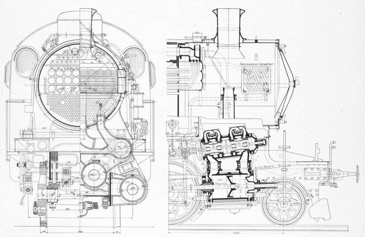
Abb. 5 und 6. Querschnitte und Längsschnitte der Doppel-Zwilling-Lokomotive C5/6. — Masstab 1:35.
