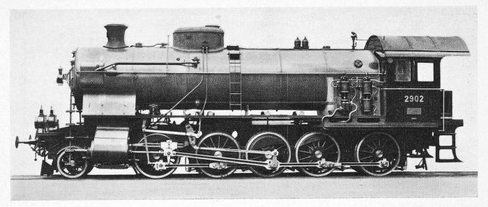
Abb. 1. Doppel-Zwilling-Heissdampfmaschine Serie C5/6 der S.B.B., mit Speisepumpe und Speisewasser-Vorwärmer.
