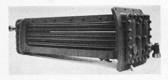
Abb. 15. Speisewasser-Vorwärmer in der Rauchkammer.
