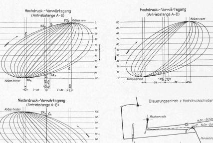
Abb. 13 (links) u. Abb. 14 (rechts) Schieberellipsen.
