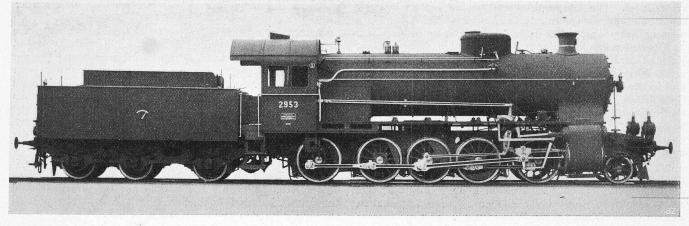
Abb. 2. Vierzylinder-Verbundlokomotive Serie C5/6 der S. B. B., gebaut von der Schweiz-Lokomotivfabrik Winterthur.
