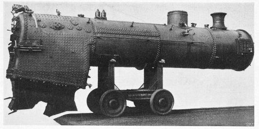
Abb. 7. Kessel mit Rauchkammer-Vorwärmer der C5/6 Doppel-Zwilling-Lokomotive.
