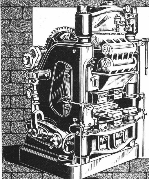
Unsere Spezialabteilung für Kalk-Sandstein-Industrie liefert leistungsfähige, sachgemäß konstruierte Misch- und Aufbereitungsmaschinen, Kugelmühlen, Erhärzungskessel etc. Unsere Steinpressen sind für stündliche Lieferungen von 1000 bis 3000 Steine bei einem ausgeübten Druck von 430 kg per cm<sup>2</sup> gebaut, der Druck ist bei jeder Pressung ablesbar. — Eigene Versuchsanlage; Referenzen, Kataloge, Ingenieurbesuch a. Wunsch.
