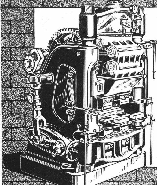
Unsere Spezialabteilung für Kalk-Sandstein-Industrie liefert leistungsfähige, sachgemäß konstruierte Misch- und Aufbereitungsmaschinen, Kugelmühlen, Erhärzungskessel etc. Unsere Steinpressen sind für stündliche Lieferungen von 1000 bis 3000 Steine bei einem ausgeübten Druck von 430 kg per cm<sup>2</sup> gebaut, der Druck ist bei jeder Pressung ablesbar. — Eigene Versuchsanlage; Referenzen, Kataloge, Ingenieurbesuch a. Wunsch.
