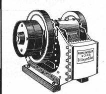
Backenbrecher mit Gehäuse aus Dillinger Panzerstahlplatten
