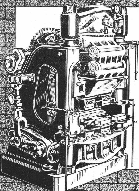
Unsere Spezialabteilung für Kalk-Sandstein-Industrie liefert leistungsfähige, sachgemäß konstruierte Misch- und Aufbereitungsmaschinen, Kugelmühlen, Erhärzungskessel etc. Unsere Steinpressen sind für stündliche Lieferungen von 1000 bis 3000 Steine bei einem ausgeübten Druck von 430 kg per cm<sup>2</sup> gebaut, der Druck ist bei jeder Pressung ablesbar. — Eigene Versuchsanlage; Referenzen, Kataloge, Ingenieurbesuch a. Wunsch.
