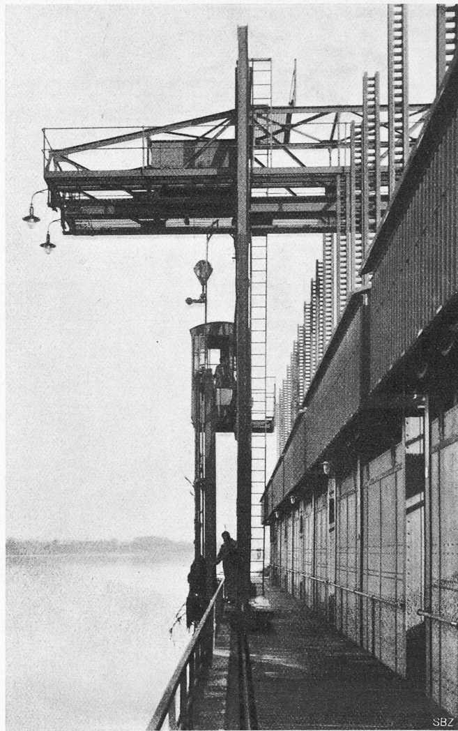
Abb. 6. Heben und Reinigen eines Grobrechen-Feldes.
