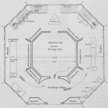
Abb. 3. Erdgeschoss-Horizontalschnitt mit Angabe der ausgestellten Eisenbau-Modelle. — Masstab 1:250.
