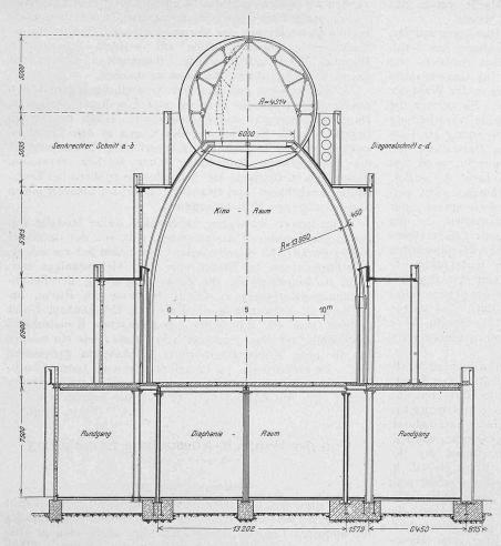
Abb. 4- Vertikalschnitt des Monument des Eisens.
