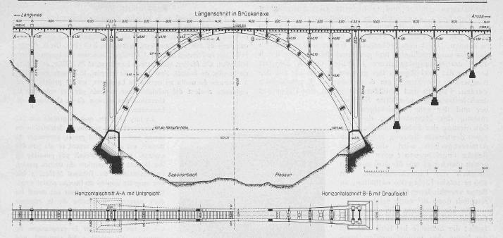
Abb. 18. Längsschnitt, Horizontalschnitte, Draussicht und Untersicht des Langwieser-Viadukts. — Masstab 1:1000.
