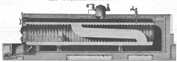
Intensivste Wasserzirkulation. Hervorragende Neuerung im Dampfkesselbau.
