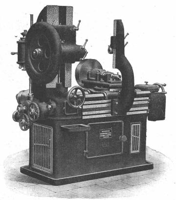
"Wanderer" Automatische Stirnräder-Fräsmaschine
