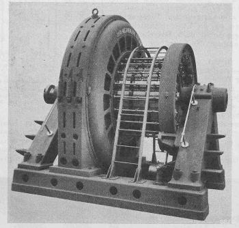
Abb. 26. Gleichstromgenerator M. F. O. für 2000 Amp. bei 250 Volt.
