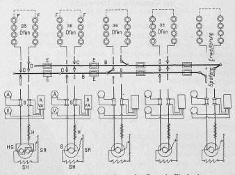
Abb 30. Schaltungsschema der Zentrale Vigeland. LEGENDE: A Ampèremeter, B Sammelschienen, C Trennschalter, E Expansionsstücke, F Aluminium-Oefen, G Generatoren, HG Hilfsgenerator, H Hilfspolwicklung, RVA Registrier-Volt-Amp.-Meter, S Shuntwiderstand, SH Shunt, SR Shunt-Regulator, V Voltmeter.
