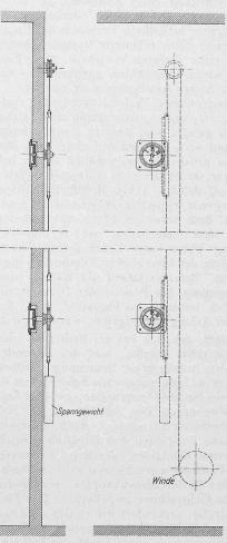
Abb. 12. Mechanische StockwerksAnzeige-Vorrichtung. — Schema 1:20.
