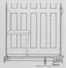
Abb. 11. Beweglicher Kabinenboden. — 1:20.
