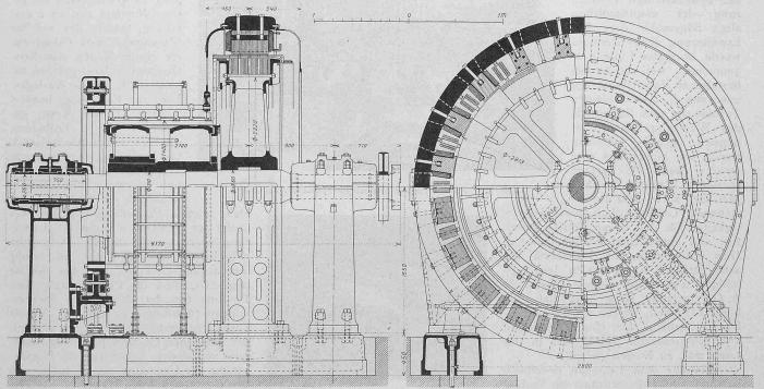
Abb. 27. Gleichstromgenerator der Maschinenfabrik Oerlikon für 2000 Amp. bei 250 Volt. - Masstab I:40.
