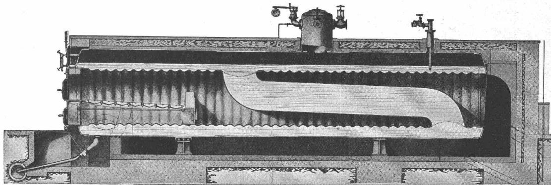
Hervorragende Neuerung im Dampfkesselbau. Intensivste Wasserzirkulation.
