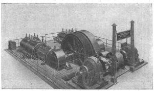
Zur Ueberfragung von 800 PS werden von dem 24 rilligen Schwungrad unter Anwendung einer von uns gelieferten Bandage nur 805 mm benötigt.
