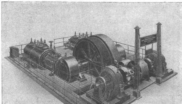
Zur Uebertragung von 800 PS werden von dem 24 Zolligen Schwungrad unter Anwendung einer von uns gelieferten Bandage nur 805 mm benötigt.
