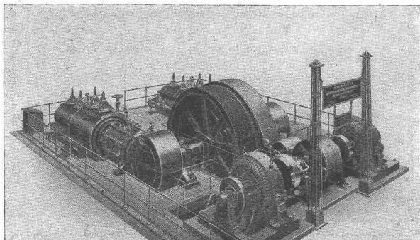
Zur Uebertragung von 800 PS werden von dem 24 tlligen Schwungrad unter Anwendung einer von uns gelieferten Bandage nur 805 mm benötigt.
