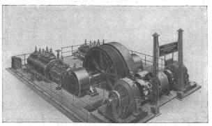
Zur Ueberfragung von 800 PS werden von dem 24 rilligen Schwungrad unter Anwendung einer von uns gelieferten Bandage nur 805 mm benötigt.
