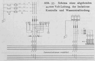
Legende: A Ampèremeter, MR Maximalstrom-Relais, D Drosselspulen, T Trennschalter, H Hörner, W Wasserwiderstände, E Erdleitung. V Voltmeter, S Sicherungen, WE Wasserstrahlerder.
