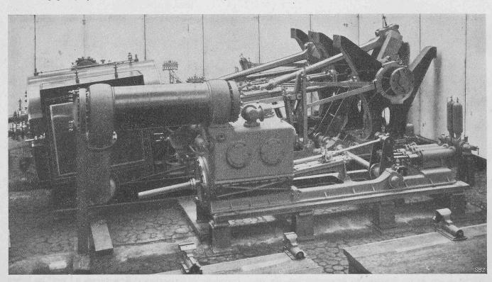
Abb. 5. 1000 bis 2000 PS-Zweizylinder-Verbund-Schiffsmaschine (Niederdruckseite) des Schleppdampfers «France».
