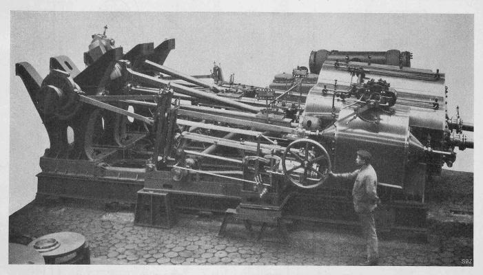
Abb. 6. 1000 bis 2000 PS-Zweizylinder-Verbund-Schiffsmaschine (Hochdruckseite) des Schleppdampfers «France».
