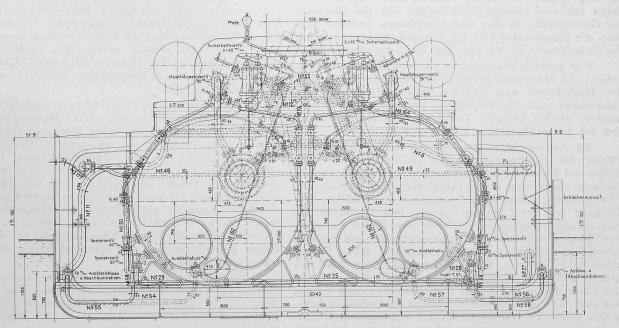
Querschnitte des Schleppdampfers «France»: Abb. 7 Spant 56; Abb. 8 Spant 73 und Abb. 9 Spant 91 (von vorn gesehen).
