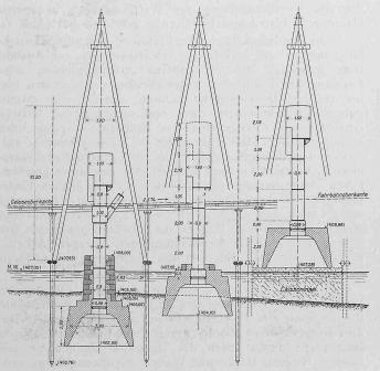
Abb. 2. Charakteristische Caissonlagen. — 1:250.
