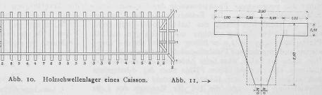
Schwellen 3, wobei jeweilen unmittelbar nach dem Freilegen Material unterstampft wird; dann folgen die Schwellen 4 u. s. f., während die letzten 7 und 8 meistens durch das Caissongewicht geknickt werden. Daraus ergibt sich der ungünstigste Belastungsfall, nämlich der, dass der Caisson eine Zeit lang frei auf den Schwellen 7 aufliegt.
