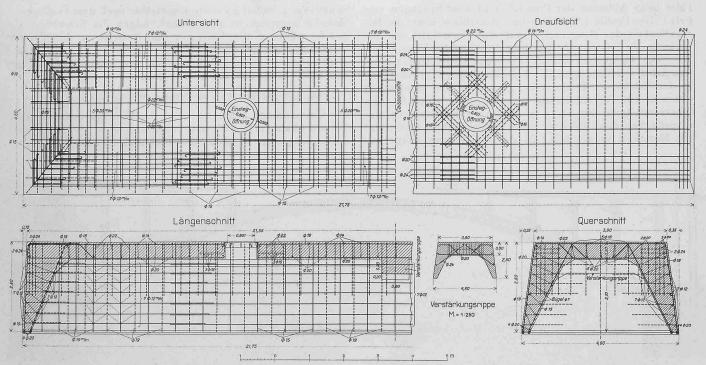
Abb. 7. Armierungsplan eines Eisenbeton-Caisson der Walchebrücke, Bauart Locher & Cie. — 1:100.
