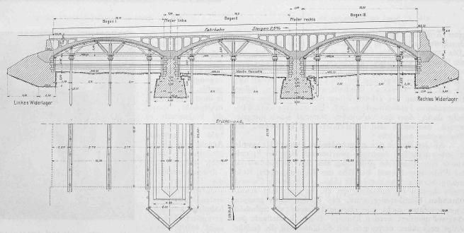
Abb. 1. Die Walchebrücke in Zürich. — Längsschnitt und halber Grundrisss. — Masstab 1:350.
