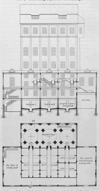
Abb. 1. Zellulosefabrik Attisholz. — Längenschnitt des Aufbereitungsgebäudes und Horizontalschnitt auf Kote + 3 m. — 1:400 $_{\rm I}$
