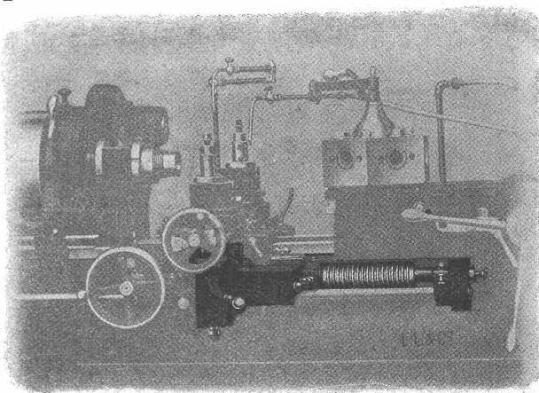
An den grossen Loewe'schen Revolverbänken kann der neuartige oben dargestellte **Gewindeschneid-Apparat** am **Quersupport** angebracht werden, welcher zur raschen Herstellung genauer Innen- und Aussengewinde mittelst Leitspindel dient. Der Rückzug des Gewindestahls am Ende und die Anstellung am Anfang des erzeugten Gewindes wird durch eine Spezialeinrichtung erleichtert.
