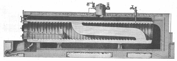
Hervorragende Neuerung im Dampfkesselbau. Intensivste Wasserzirkulation.
