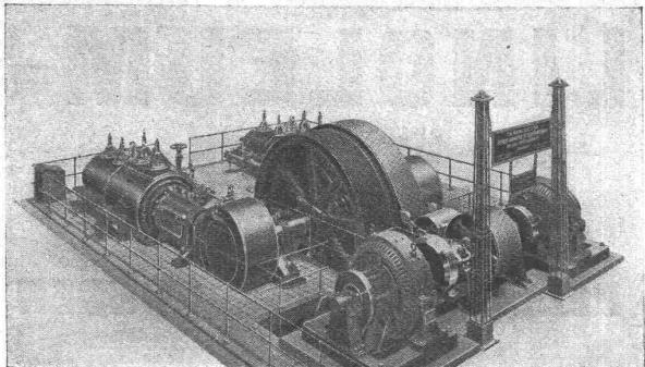
Zur Übertragung von 800 PS werden von dem 24 Zolligen Schwungrad unter Anwendung einer von uns gelieferten Bandage nur 805 mm benötigt.
