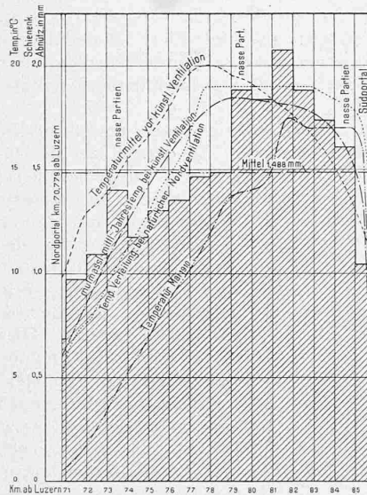
Abb. 8. Schienenkopfabnutzung und meteorologische Verhältnisse im Gotthardtunnel.
