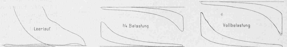
Abb. 44. Indikator-Diagramme des 25 PS-Gasomotors mit Füllungsregelung der S. L. M. Winterthur.
