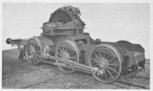
Abb. 20. Drehgestell der elektrischen Lötschberg-Lokomotive Nr. 121.
