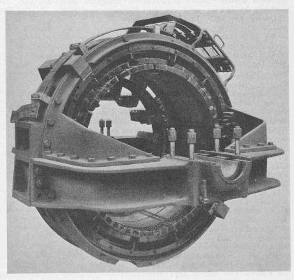
Abb. 25. Stator des 1000 PS-Lokomotivmotors der M. F. O.
