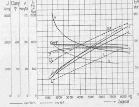
At b. 27. Motorkurven des Lokomotivmotors.
