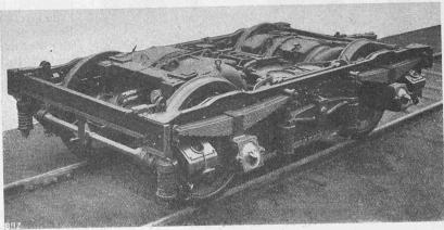
Abb. 7. Draufsicht des Drehgestells zum Motorwagen.
