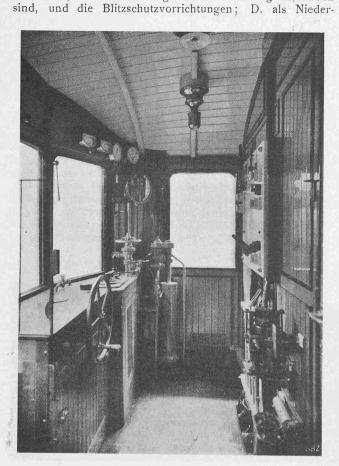
Abb. 9. Führerstand mit Steuerschalter.
