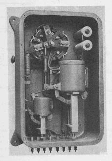
Abb. 18. Schaltkasten zum Licht-Umformer.
