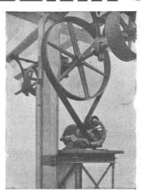
Die Abbildung zeigt den Antrieb einer Transmission durch einen Elektromotor mittelst "Lenix".
