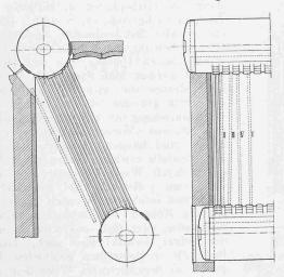
Abb. 17. Einziehen von Röhren beim Garbekessel.
