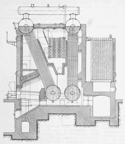
Abb. 13. Zweibündel-Garbe-Kessel für 200 bis 800 m² Heizsläche. — 1:100.
