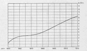
Abb. 1. Entwicklung des mittlern Kesseldrucks von 1850 bis 1910.
