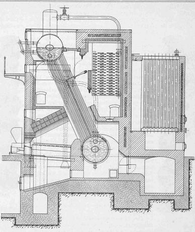
Abb. 12. Einbündel-Garbe-Kessel, bis 200 m<sup>2</sup> Heizstäche. — Masstab 1:100.
