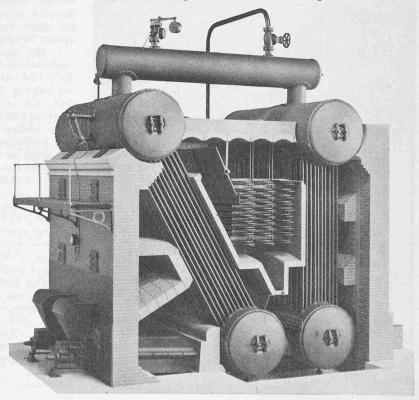
Abb. 14. Zweibundel-Garbe-Kessel mit Unterschubseuerung von Gebr. Sulzer, Winterthur.
