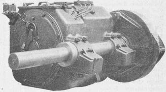
Abb. 16. Motor des Motorwagens.
