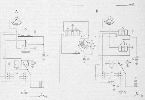
Abb. 10. Stromlaufschema des Apparates von Firth und Leake.
