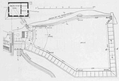
Abb. 29. Lageplan von Wasserschloss und Ausgleichbecken Cedegolo. — 1:800.
