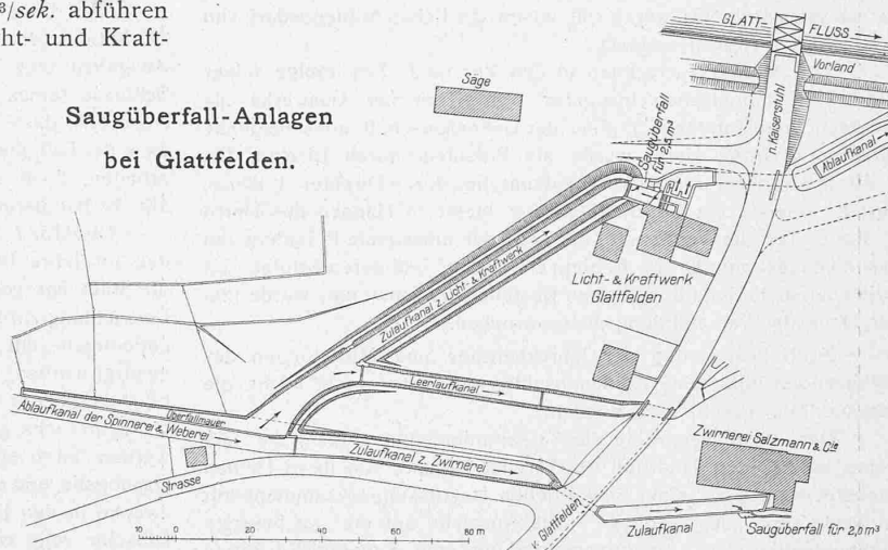
Abb. 15. Lageplan der Anlagen des Licht- und Kraftwerks und der Zwirnerei Salzmann & Cie. in Glattfelden. — Masstab 1 : 2000.
