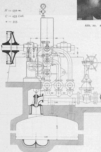
Abb. 21. 2500 PS-Hochdruckturbine mit Druckregulierung. - 1:50.
