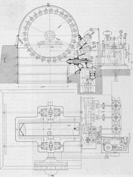
Abb. 20. 2500 PS-Hochdruckturbine von Escher Wyss & Cie., Zürich. + 1:50.
