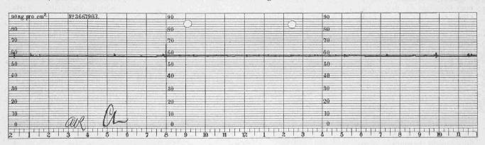
Abb. 26. Druck-Diagramm, Rohrstrang rechts. Die Anschläge beider Diagramme um 8 Uhr rühren vom Auswechseln der Streifen her.
