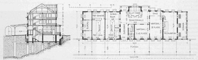
Abb. 2. Schnitt in Gebäudemitte und Erdgeschoss-Grundriss des Aufnahmegebäudes Herisau — Masstab 1:500.
