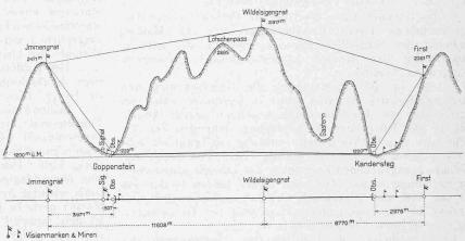
Abb. 2. Längenprofil der oberirdischen Absteckung. — Längen 1:200000, Höhen 1:50000.
