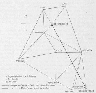
Abb. 1. Dreiecksnetz zur Absteckung des Lötschbergtunnels. Masstab 1: 200 000.
